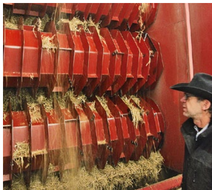
Riesige Walzen lösen die Ballen auf, bevor eine unten liegende Trogschnecke das Stroh Richtung Ofen fördert.
