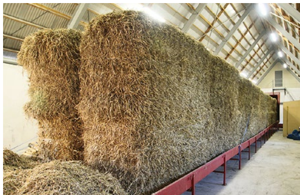
Bis zu 36 Großballen können auf dem Zuführband der Stroheizung gelagert werden. Maximal gebraucht werden sechs Ballen pro Tag.
